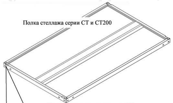
При установке полок стеллажа серии СТ на клипсы или зацепы замок-«язычок» загнуть в паз.
